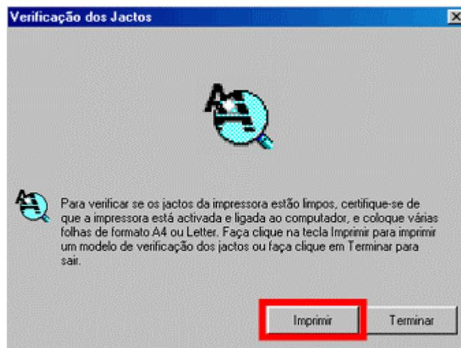
A impressora imprime a verificação dos jactos. Compare essa impressão com o conteúdo da próxima janela. Se a impressão tiver falhas ou áreas ténues, faça clique em **Limpar**. Se a impressão estiver correcta, faça clique em **Terminar**.
