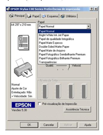
Certifique-se de que está a utilizar papel EPSON e de que seleccionou correctamente o tipo de papel no controlador. Verifique se o papel está colocado com a face de impressão voltada para cima.
