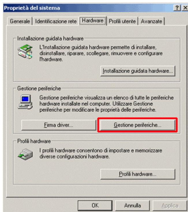
Per verificare che i controller USB (Universal serial bus) funzionino e siano installati correttamente, fare clic sul segno + accanto al componente. Se i **controller USB (Universal serial bus)** non sono visualizzati oppure sono contrassegnati da un punto interrogativo o esclamativo, richiedere ulteriore assistenza al fornitore del computer.
