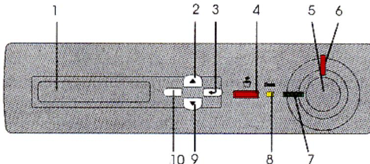
**1) Panneau LCD** : affiche les messages d'état de l'imprimante et les paramètres des menus du panneau de commande.
