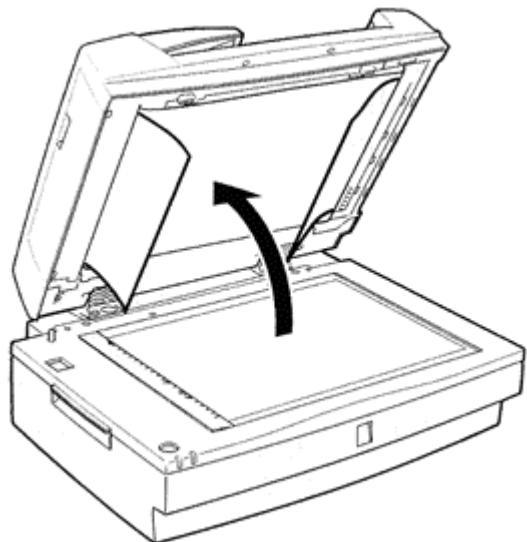
Si le bourrage papier s'est produit au niveau du chargeur : Ouvrez le capot de gauche et tirez le papier bloqué, avec précaution, hors du mécanisme de chargement.
