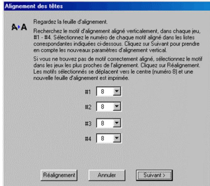
Les têtes sont correctement alignées lorsque les lignes imprimées sont alignées au centre (case numéro 8).
