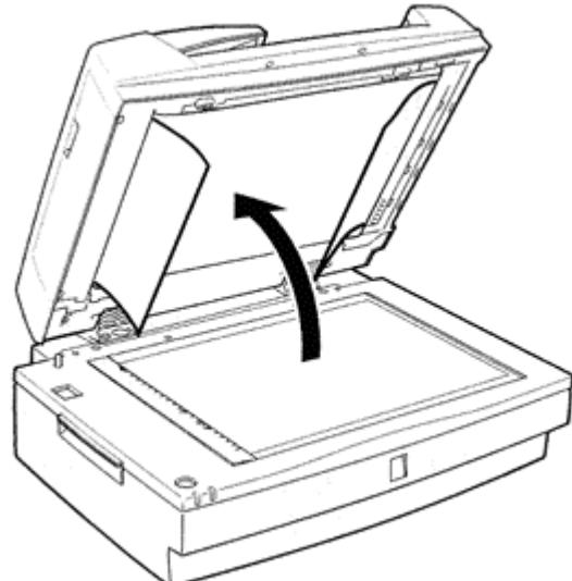
Si el papel se atasca en la posición del alimentador: abra la cubierta izquierda y retire con cuidado el papel atascado del mecanismo del alimentador.
