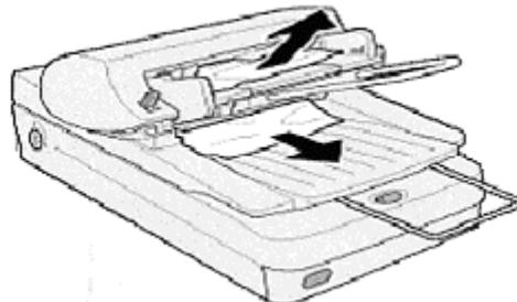
Wenn der Papierstau auf diese Weise nicht entfernt werden kann, öffnen Sie die hintere Abdeckung, um besseren Zugang zu erhalten.
