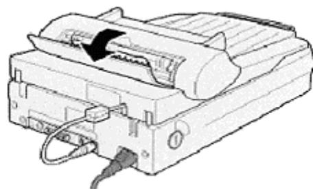
Stellen Sie nach dem Beseitigen des Papierstaus sicher, dass der ADF richtig eingesetzt und die hintere Abdeckung wieder geschlossen ist.
