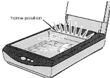
Trennen Sie das USB-Kabel vom Scanner. Trennen Sie das AC-Adapter, und schieben Sie die Transportsperre nach links in die Sperrposition. Zur Verwendung des Scanners entsperren Sie diesen wieder.
