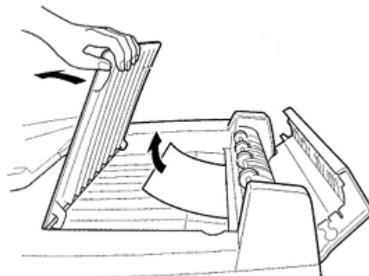
Schließen Sie nach dem Entfernen des Papierstaus die Abdeckung des automatischen Dokumenteneinzugs.
