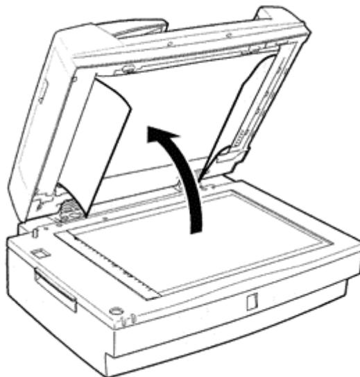
Bei Papierstau am Einzug: Öffnen Sie die linke Abdeckung, und ziehen Sie das gestaute Papier vorsichtig aus der Einzugsvorrichtung.
