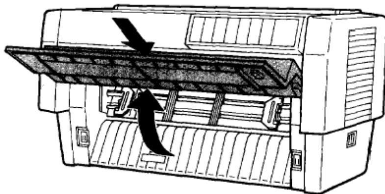
3. Die DIP-Schalter befinden sich hinter dem vorderen Papiereinzug an der vorderen Papierführung. Wenn im vorderen Papiereinzug Papier eingelegt ist, entfernen Sie es bzw. heben Sie es an, so dass Sie die DIP-Schalter erreichen können.
