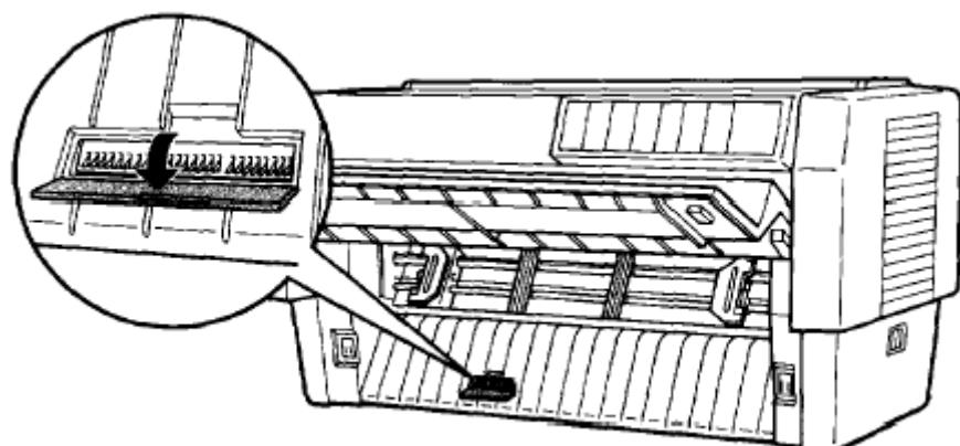
5. Verwenden Sie einen spitzen Gegenstand, wie z. B. die Spitze eines Kugelschreibers, um den Schalter ein bzw. auszuschalten. Der DIP-Schalter ist aktiviert, wenn er sich in der oberen Position befindet.
