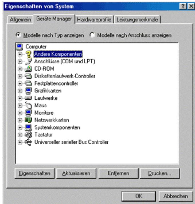
Überprüfen Sie, ob neben diesen Einträgen Fragezeichen stehen. Ist dies der Fall, wurde der Scanner nicht ordnungsgemäß installiert. Führen Sie die folgenden Schritte durch, um den Fehler zu beheben.
