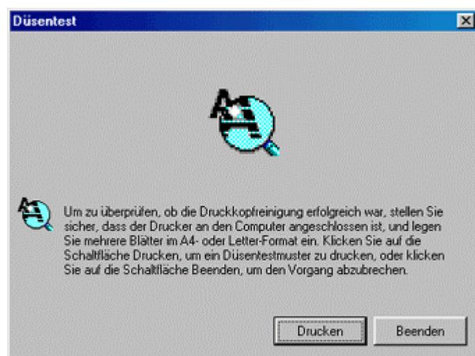
Der Drucker druckt ein Düsentestmuster. Vergleichen Sie den Ausdruck mit dem Muster im folgenden Fenster. Wenn der Ausdruck Lücken oder fehlerhafte Stellen enthält, klicken Sie auf **Reinigen**. Wenn der Ausdruck korrekt ist, klicken Sie auf **Beenden**.
