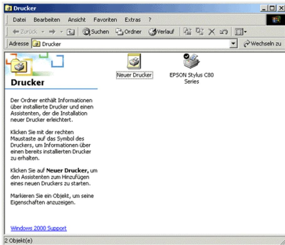
Klicken Sie mit der rechten Maustaste auf den gewünschten Drucker, und wählen Sie die **Option Druckeinstellungen** aus. Die Treibereinstellungen werden angezeigt.
